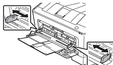
7 根據紙張大小展開紙張支撐板，避免紙張從印表機滑落。
