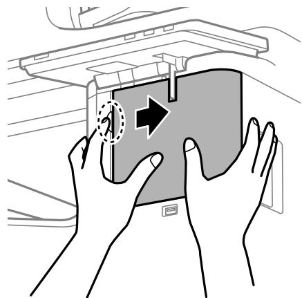
4. 무선 LAN 인터페이스-P1의 접이식 시트가 보이도록 하여 위쪽 Wi-Fi 장치 포트에 단단히 삽입합니다.
