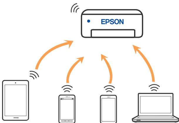
프린터는 Wi-Fi나 이더넷, Wi-Fi Direct(Simple AP) 연결로 동시에 연결할 수 있습니다. 단, Wi-Fi로 프린터가 연결되어 있는 동안 Wi-Fi Direct(Simple AP) 연결로 네트워크 연결을 시작하면 Wi-Fi 연결은 일시 중단됩니다.
