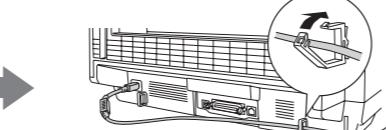
按图示连接电源线。 使用左侧或右侧的线缆支架固定线缆。
