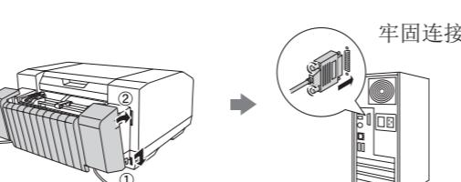
安装连接器盖。将数据线的另一端牢固地连接到计算机。并拧紧两边的螺丝。
