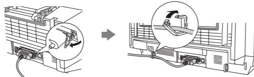
按图示将并口数据线插紧并按上图用固定扣固定,如果有接地线,须将接地线固定并拧紧螺丝。
