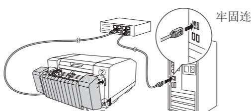
安装连接器盖。将以太网的另一端连接到路由器。再使用另一根网线连接路由器至计算机。
