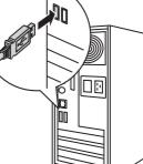
将数据线的另一端牢固地连接到计算机。
