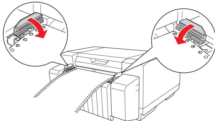
8. Передвиньте правую звездочку таким образом, чтобы устранить малейшее провисание бумаги, и зафиксируйте положение звездочки.
