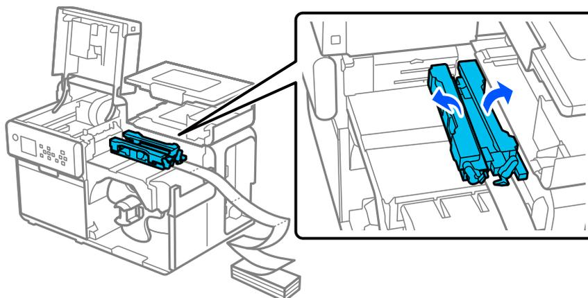
**4** Нажимая на синий рычаг, сдвиньте подвижную боковую направляющую к себе до конца.
