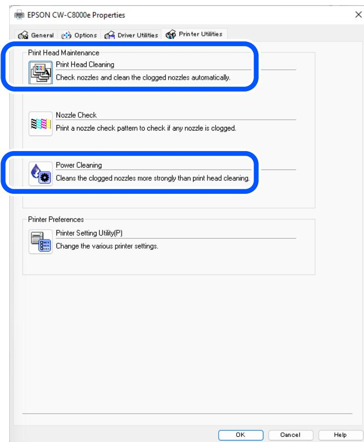
**Upotreba WebConfig-a**Izaberite **Print Head Cleaning** u prozoru **Maintenance**. Zatim izaberite vrstu čišćenja između **Auto** i **Power Cleaning**, a zatim kliknite na **Start**.
