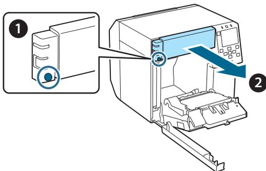
5. Отключите разъем модуля автоматического резака от принтера.
