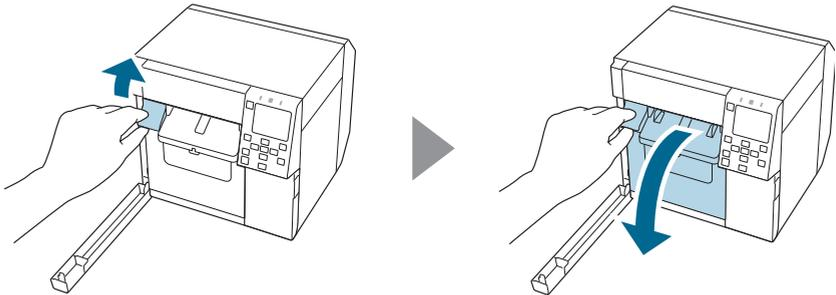
4. 用十字螺丝刀松开一颗螺丝，然后拆下自动裁纸刀盖组。
