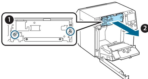
7. Installer auto-skærerenheden til udskiftning. Juster hullerne på venstre og højre side af skærerenheden med fremspringene på printeren. Ellers fungerer enheden muligvis ikke korrekt.
