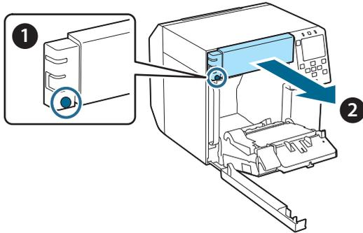
5. 從印表機上拔下自動裁刀裝置的接頭。
