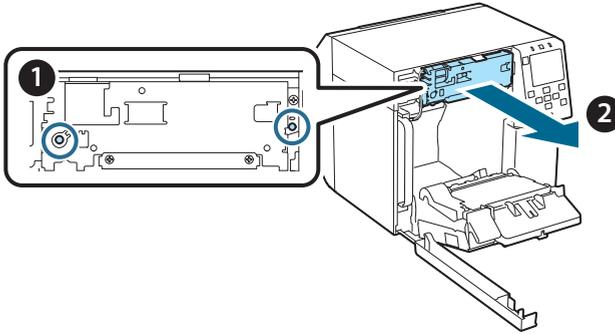
7. Pasang unit pemotong otomatis pengganti. Sejajarkan lubang di sisi kiri dan kanan unit pemotong dengan tonjolan pada printer. Jika tidak, unit mungkin tidak beroperasi dengan benar.
