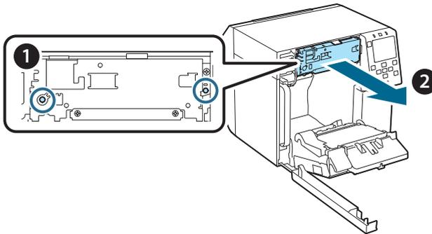
7. Installeer de vervangingseenheid voor de automatische snijdereenheid.
