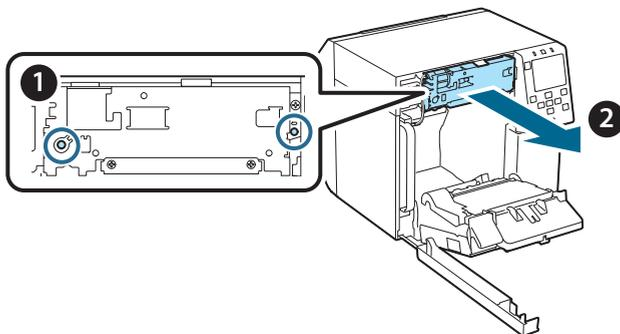
7. Установите сменный модуль автоматического резака. Совместите отверстия на левой и правой сторонах модуля автоматического резака с выступами на принтере. В противном случае устройство может работать неправильно.
