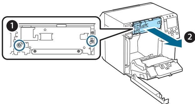
7. Asenna automaattisen leikkurin vaihtoyksikkö paikalleen. Kohdista leikkuriyksikön vasemmalla ja oikealla puolella olevat reiät tulostimen ulokkeisiin. Muutoin yksikkö ei ehkä toimi oikein.
