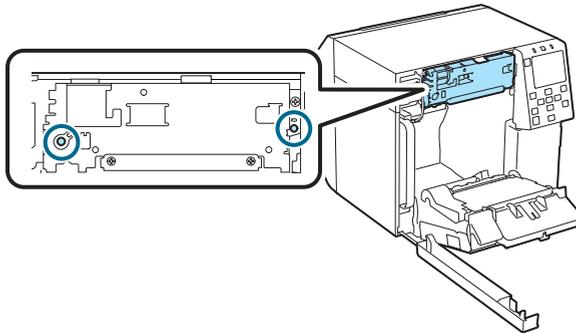
**9. Sluit de aansluiting van de automatische snijdereenheid op de printer aan, en let er daarbij op dat u deze in de juiste richting houdt.**
