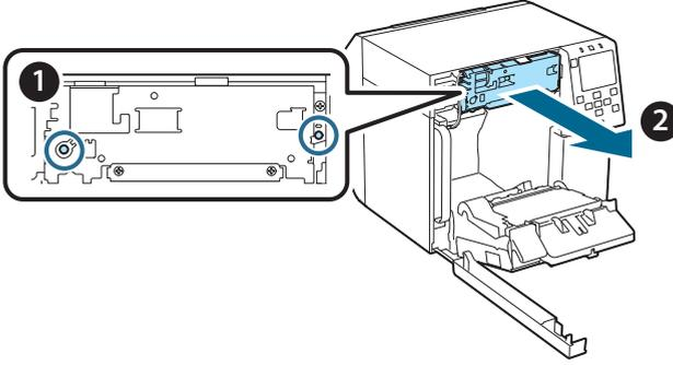
7. Yedek otomatik kesici ünitesini takın. Kesici ünitesinin sol ve sağ taraflarındaki delikleri yazıcıdaki çıkıntılarla hizalayın. Aksi takdirde, ünite düzgün çalışmayabilir.
