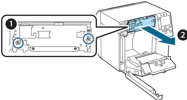
7. 安装替换的自动裁纸刀装置。
