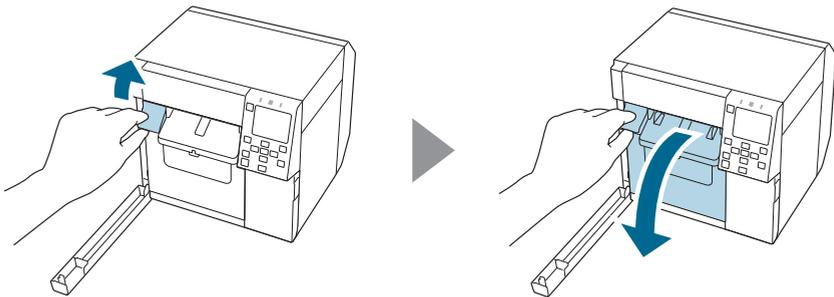
4. Draai één schroef los met een phillips-kruiskopschroevendraaier en verwijder vervolgens de afdekking van de automatische snijder.
