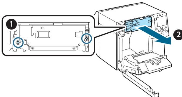
7. Installer reserveenheten for den automatiske kutteren. Rett inn hullene på venstre og høyre side av kutterenheten etter fremspringene på skriveren. Ellers kan det hende at enheten ikke fungerer som den skal.
