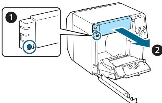
5. Odspojite priključak jedinice automatskog rezača s pisača.
