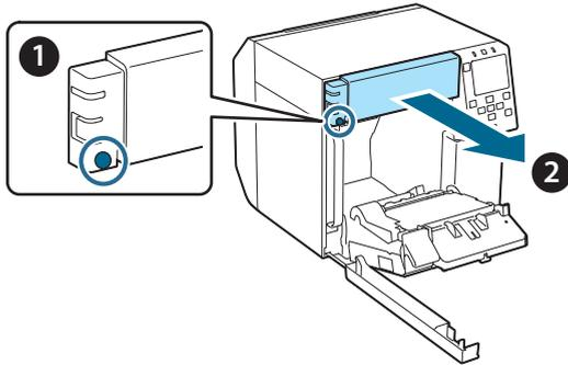
5. 从打印机上拔下自动裁纸刀装置的接头。
