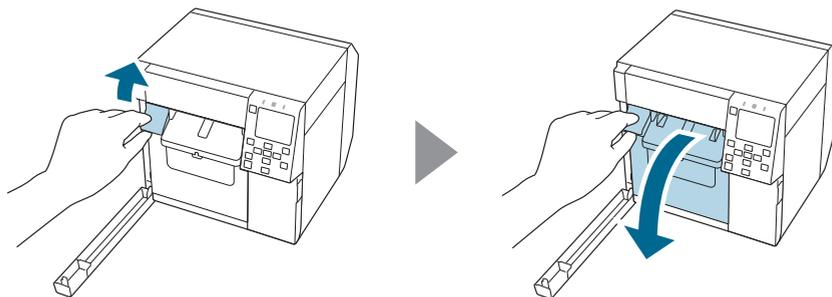
4. Odvijte en vijak s križnim izvijačem in nato odstranite komplet pokrovov avtomatskega rezalnika.
