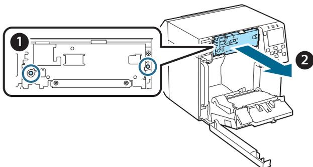
7. 交換用のオートカッターユニットを取り付けます。左右にある穴を、本体の突起に合わせてください。合っていないと正常に動作しなくなるおそれがあります。
