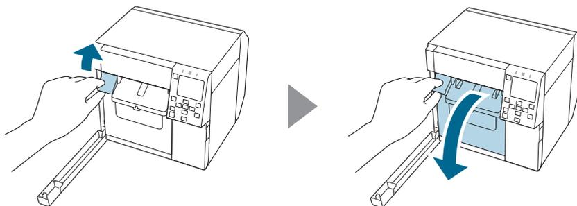
4. Развийте един винт с отвертка „Phillips“ и след това отстранете капака на автоматичния нож.
