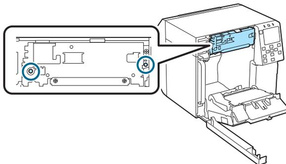
**9. Подключите разъем модуля автоматического резака к принтеру с учетом его ориентации.**
