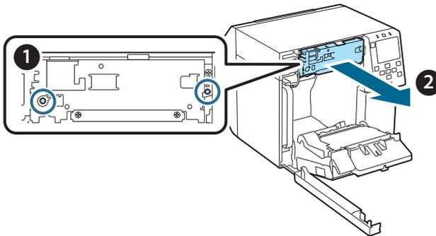
7. Instalați unitatea cuțit automat de schimb. Aliniați orificiile de pe partea stângă și dreaptă ale unității cuțit cu proeminențele de pe imprimantă. În caz contrar, este posibil ca unitatea să nu funcționeze corect.
