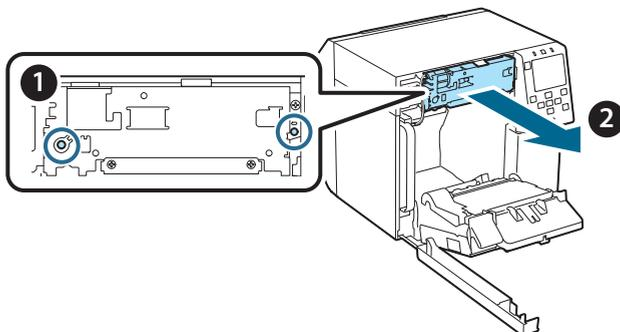
7. Namestite nadomestno enoto za avtomatsko rezanje. Poravnajte luknje na levi in desni strani enote za rezanje z izboklinami na tiskalniku. V nasprotnem primeru enota morda ne bo pravilno delovala.
