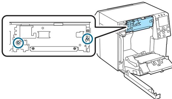
9. 将自动裁纸刀装置的接头连接到打印机，注意其方向。
