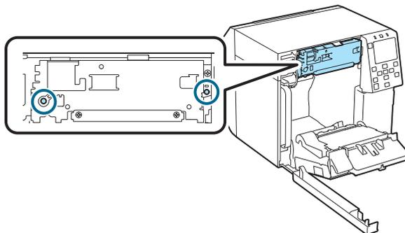
**9. Ligue o conector da unidade cortadora automática à impressora, prestando atenção à orientação.**
