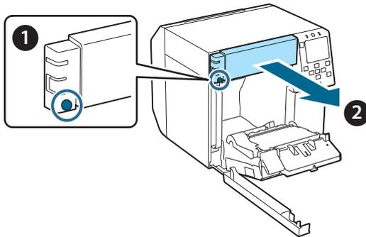
5. Trennen Sie den Anschluss der automatischen Schneidevorrichtung vom Drucker.
