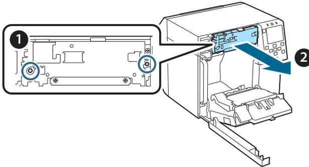
7. Installieren Sie die Ersatzeinheit für die automatische Schneidevorrichtung.
