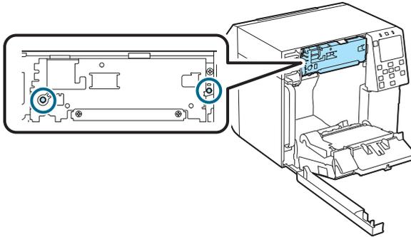
9. **Verbinden Sie den Anschluss der automatischen Schneidevorrichtung mit dem Drucker und achten Sie dabei auf die Ausrichtung.**
