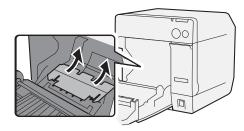
3 リストバンド専用アタッチメントを、ロール紙カバー の内側の溝に差し込んで取り付けます。
