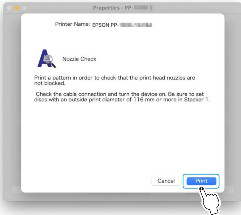
يتم إخراج الاسطوانة التي تم طباعة نمط فحص الفوهة عليها إلى المكبس 3 أو المكبس 4.
