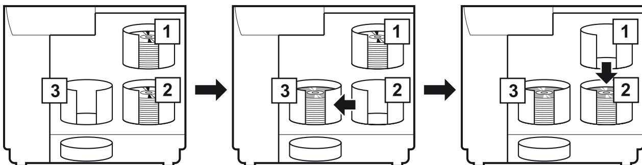
عندما يتم نشر الاسطوانات في Batch Mode (وضع الحزمة)، لا يتطابق عدد الاسطوانات التي تم تحميلها في المكبس 2 وعدد الاسطوانات التي تم إخراجها إلى المكبس 3 دائمًا. أيضًا، قد لا يتم إخراج 50 اسطوانة. الأمر نفسه ينطبق على الاسطوانات التي تم إخراجها إلى المكبس 2.
