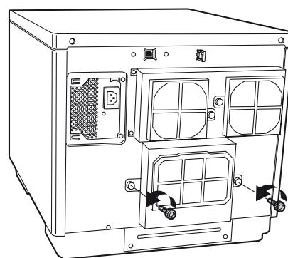
4 قم بامساك أداة التثبيت الموضحة في الشكل أدناه، وقم بدفع درج الطابعة في اتجاه الأسهم المشار إليه أدناه.
