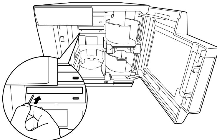
**! Veillez à ce que le produit soit hors tension lors de l'insertion de l'épingle dans l'orifice d'éjection.**
