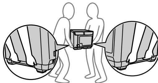
Le produit doit être soulevé des deux côtés, par deux personnes tenant les évidements situés sur les côtés, comme indiqué sur l'illustration de gauche. Le fait de soulever le produit par une partie autre que celles indiquées dans l'illustration de
