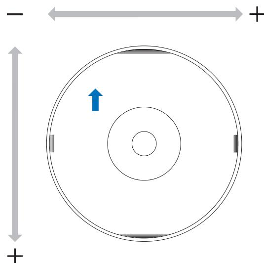
**5** Cliquez sur **Terminer** si les lignes du haut, du bas, de gauche et de droite sont imprimées de manière uniforme sur la surface de l'étiquette. Si elles ne sont pas imprimées de manière uniforme, réglez l'alignement de l'une des manières suivantes.
