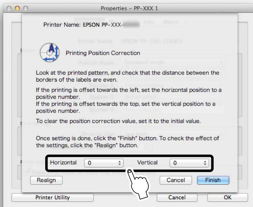
**6** Загрузите в укладчик 1 один диск, на котором отсутствует печать, и нажмите «**Realign**» (повторная регулировка).
