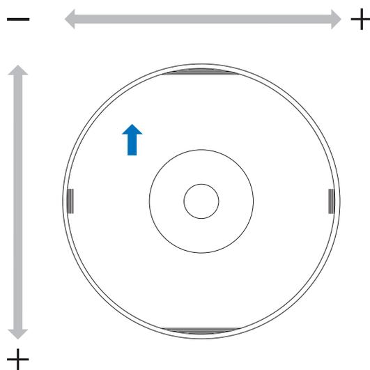
**5** Нажмите «**Finish**» (завершить), если верхняя, нижняя, левая и правая линии напечатаны равномерно. Если они напечатаны неравномерно, выполните коррекцию одним из следующих способов.
