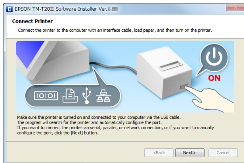
Wenn die USB-Verbindung zwischen dem Computer und dem Drucker hergestellt wurde, wird die Pop-up-Meldung **Installing device driver software (Installieren von Gerätetreibersoftware)** in der Taskleiste angezeigt und die Installation wird automatisch gestartet. Fahren Sie nach Abschluss der Installation mit Schritt 10 fort.
