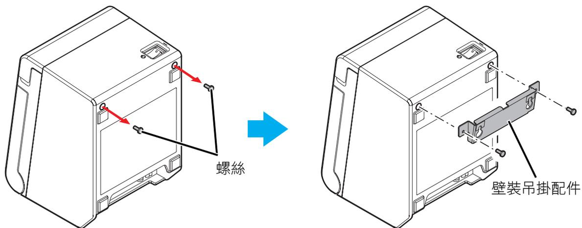
4. 將壁裝吊掛配件上的兩個孔對準牆壁上的螺絲，把印表機牢牢吊掛在牆壁上。
