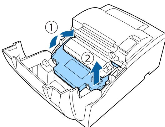
4. Installez la cassette à ruban de sorte que le ruban passe entre la tête d'impression et la platine, puis appuyez sur la cassette à ruban jusqu'à ce qu'elle s'enclenche. Vérifiez que le ruban n'est ni froissé ni plié.
