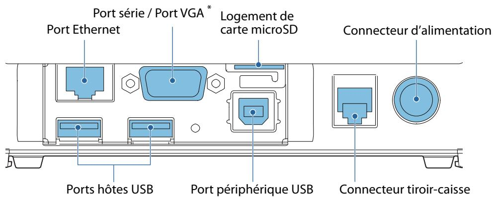
\*: Les interfaces montées varient selon le modèle d'imprimante.
