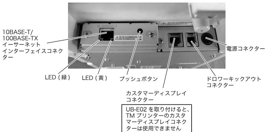
注記：写真は TM-H6000II プリンターに UB-E02 を取り付け付けた状態を示しています。
