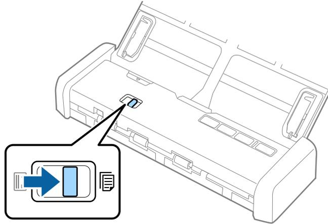
3. 升起紙張邊緣定位器並將進紙托盤向外滑到底。
