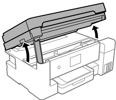
3. Vérifiez si le film translucide est taché. Les taches seront plus faciles à repérer si vous utilisez une lampe torche. S'il y a des taches (telles que des marques de doigts ou de graisse) sur le film translucide (A), passez à l'étape suivante.
