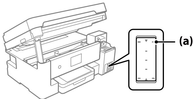
6. Alignez le haut de la bouteille d'encre sur le port de remplissage, puis insérez-le directement dans le port pour remplir l'encre jusqu'à la ligne supérieure.
