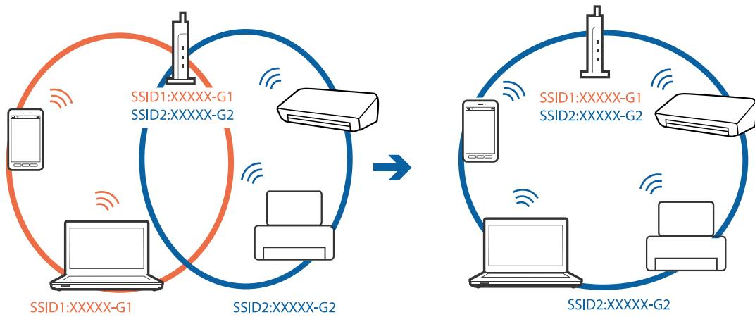
□ إحدى نقاط الوصول المتفاقة مع كل من بروتوكول IEEE802.11g وبروتوكول IEEE802.11a لديها معرفات شبكة SSID تصل إلى 2.4 غيغا هرتز و 5 غيغا هرتز. إذا قمت بتوصيل الكمبيوتر أو الجهاز الذي يُعرف بشبكة 5G SSID، فسيتعذر عليك الاتصال بالطابعة لأن الطابعة تدعم فقط الاتصال لما يزيد عن 2.4 غيغا هرتز. قم بتوصيل الكمبيوتر أو الجهاز الذي يُعرف بالشبكة SSID نفسه الذي تستخدمه الطابعة.
