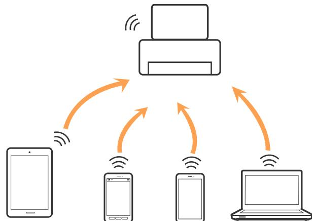
يمكن توصيل الطابعة عن طريق شبكة Wi-Fi Direct (نقطة الوصول البسيط) في وقت واحد. وبالرغم من ذلك، إذا بدأت اتصال الشبكة في وضع اتصال Wi-Fi Direct (نقطة الوصول البسيط) عندما تكون الطابعة متصلة عن طريق شبكة Wi-Fi، فسيتم قطع الاتصال بشبكة Wi-Fi بشكل مؤقت.
