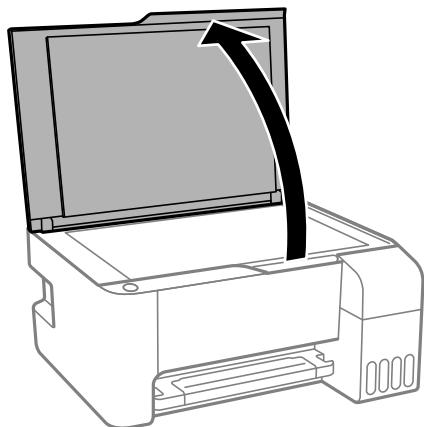
2. Elimine el polvo o las manchas de la superficie del cristal del escáner con un paño suave, seco y limpio.
