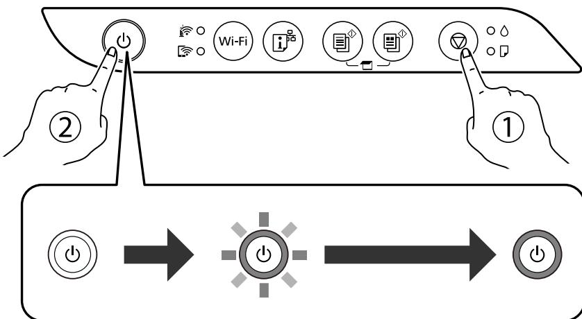
Se imprimirá el patrón del test de inyectores.
