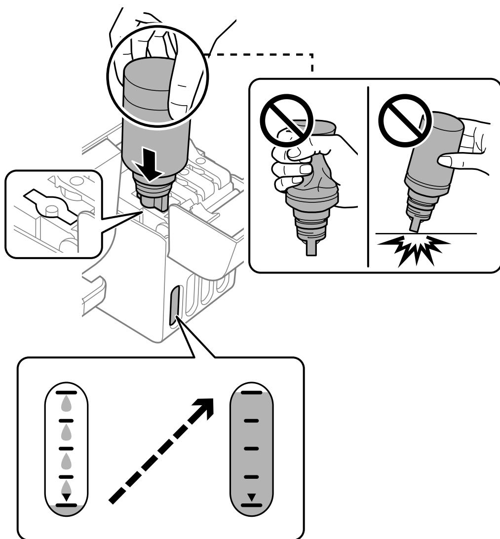
6. Cuando termine de llenar la tinta, quite el bote de tinta y cierre bien la tapa del tanque de tinta.
