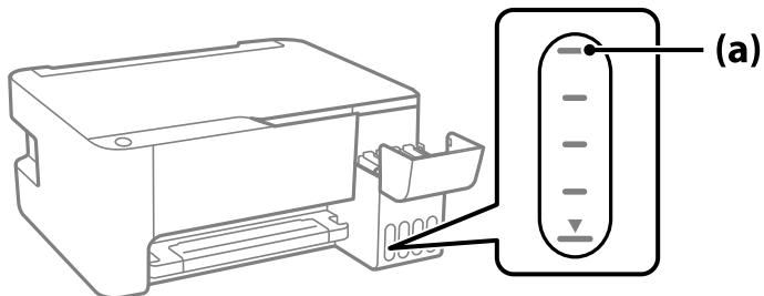
5. Alinee la parte superior del bote de tinta con el puerto de llenado y, a continuación, intodúzcalo recto en el puerto de llenado la tinta hasta que se detenga automáticamente en la línea superior.
