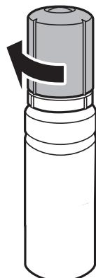
7. Cierre con firmeza la cubierta del tanque de tinta.
