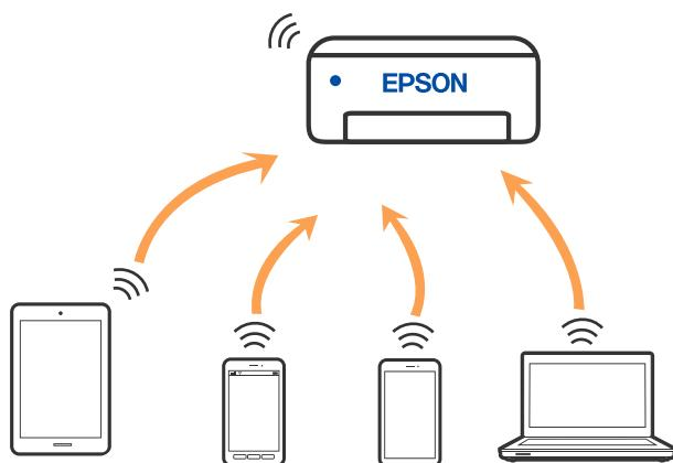
La impresora puede conectarse por Wi-Fi y por conexión Wi-Fi Direct (PA simple) simultáneamente. No obstante, si inicia una conexión de red mediante Wi-Fi Direct (PA simple) cuando la impresora está conectada por Wi-Fi, la red Wi-Fi se desconectará temporalmente.
