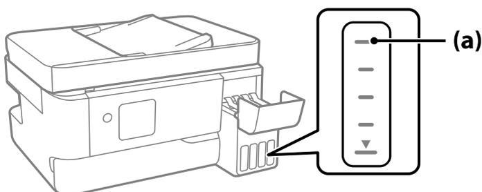
8. Alignez le sommet du flacon avec la goutlotte de remplissage, puis insérez-le dans celle-ci pour remplir l'encre jusqu'à ce qu'elle atteigne la ligne supérieure et que l'écoulement s'arrête automatiquement.
