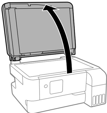
2. Nettoyez la surface de la vitre du scanner à l'aide d'un chiffon doux, sec et propre.
