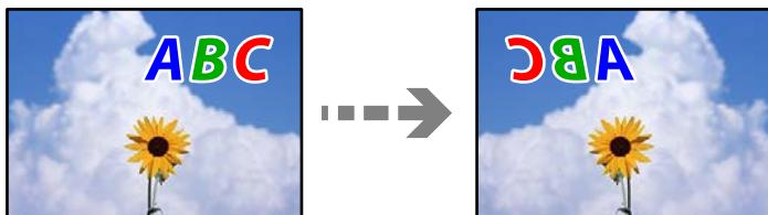
影像在列印設定中被設定為水平倒置。
