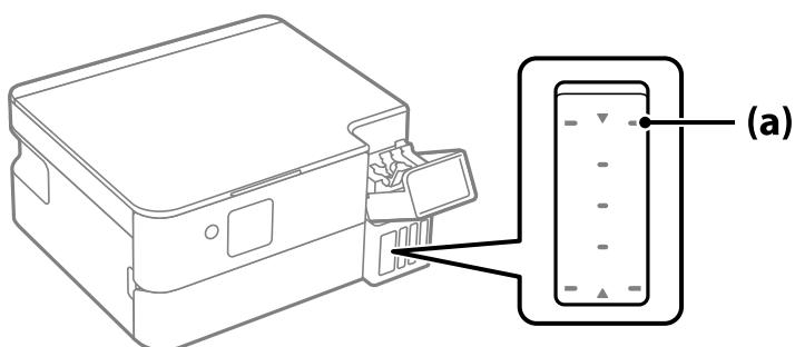
9. 將墨水瓶頂部對齊填充口，然後將其徑直插入此端口以填充墨水，直到其自動停止在最高標示線處。
