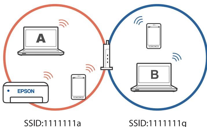
此外，如果在以上所示的配置中從電腦 B 開始設定印表機，則印表機會在電腦 B 的網路中設定，允許電腦 B (而非電腦 A) 進行列印。
