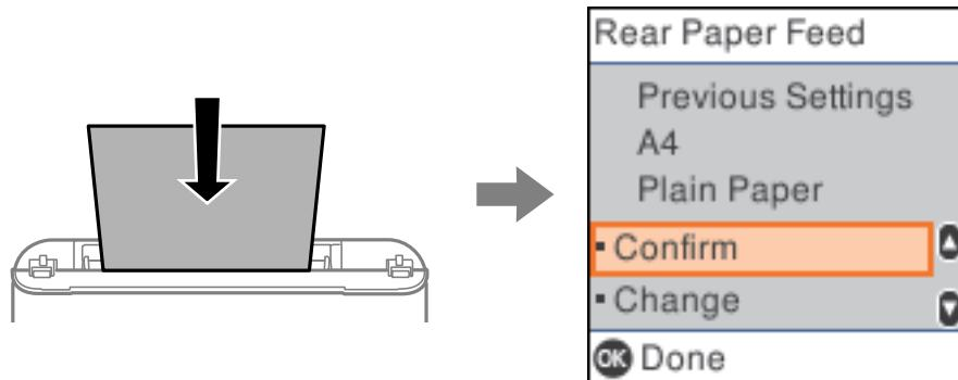
如果顯示的紙張尺寸和類型與裝入的紙張不同，變更紙張尺寸和紙張類型設定，然後確認它們。
