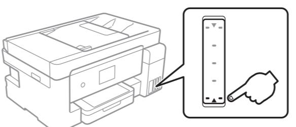
실제 잉크 잔량을 확인하려면 프린터 잉크 트客栈 내부의 잉크 트리를 윗으로 확인하십시오. 잉크 잔량이 하단 표시선 아래에 있을 때 프린터를 계속 사용하면 프린터가 손상될 수 있습니다.
