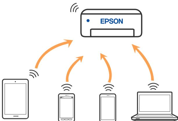
印表機可同時透過 Wi-Fi 和 Wi-Fi Direct (Simple AP) 連接方式連接。不過，如果您在 Wi-Fi 連接方式下啟動 Wi-Fi Direct (Simple AP) 方式的連接，Wi-Fi 會暫時斷開。
