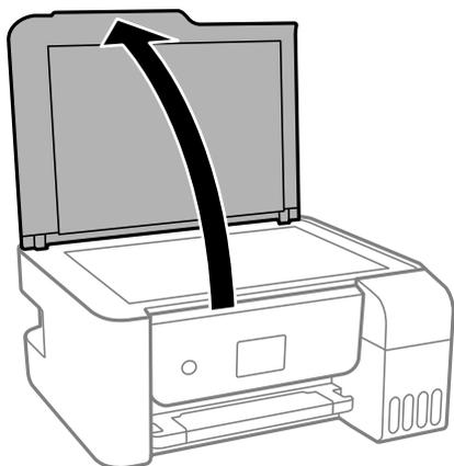
2. 用乾燥、乾淨的軟布擦除 工作平台 表面上的任何灰塵或污漬。
