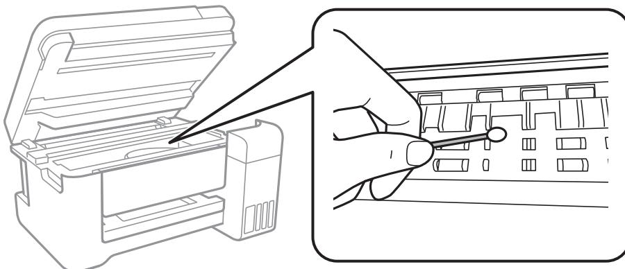
請勿碰觸印表機內部的白色排線、透明膠片及墨水導管。以免造成故障。
