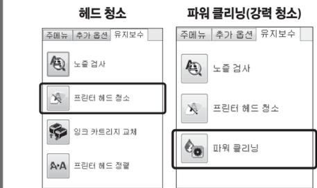
프린터 헤드 청소 및 파워 클리닝(강력 청소) 실행 시 잉크가 일부 사용됩니다. 자세한 사항은 **사용설명서**의 **프린터 유지보수** 관련 내용을 참조하십시오.
