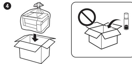
4 잉크병 캡을 닫을 때는 반드시 잉크병이 수직으로 잘 세워진 상태를 유지하십시오. 프린터와 잉크병은 반드시 비닐 봉투에 따로 넣고, 프린터를 보관할 때와 같이 수평을 유지하여 운송 및 운반하십시오. 잉크 누출의 우려가 있습니다.
