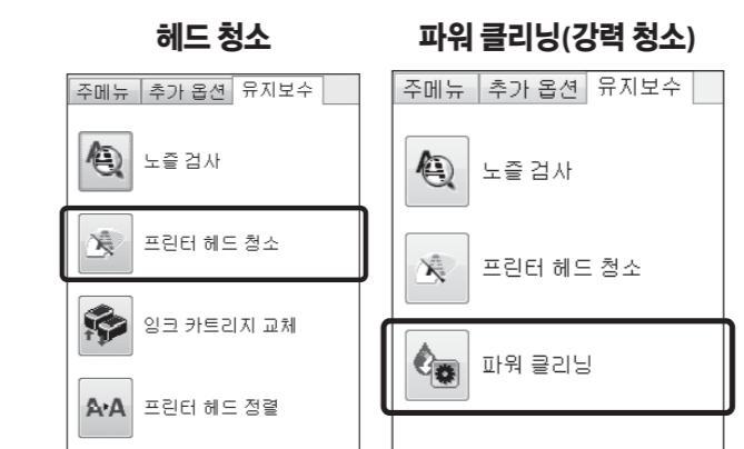
☞ 프린터 헤드 청소 및 파워 클리닝(강력 청소) 실행 시 잉크가 일부 사용됩니다. 자세한 사항은 사용설명서의 **프린터 유지보수** 관련 내용을 참조하시기 바랍니다.
