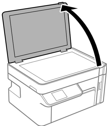
2. 用乾燥、乾淨的軟布擦除工作平台表面上的任何灰塵或污漬。
