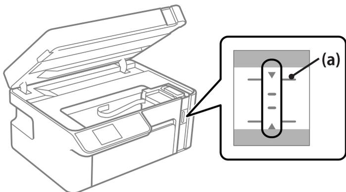
9. 將墨水瓶頂端對準填充入口，然後將其徑直插入填充入口至最高標示線處。
