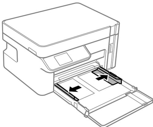
3. 將紙張的可列印面朝下，接著放入信封，直到信封接觸到進紙匣的後端為止。
