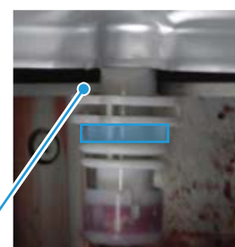
Parte intagliata della porta di erogazione della cartuccia di inchiostro
