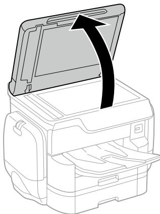
**2 スキャンする面を下にして、原点マークに合わせて原稿を置きます。**
