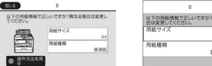
セットした用紙のサイズと種類を給紙装置に設定しておくと、給紙装置を自動選択にして印刷したときに、印刷データの用紙設定に合った用紙が自動で給紙できます。印刷のたびに給紙装置を選択する必要がなくなります。
