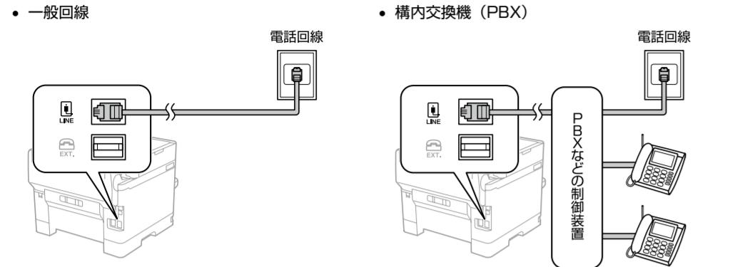
構内交換機を使った内線電話をご利用のときは、電話回線と本製品の間にPBXなどの制御装置があります。
