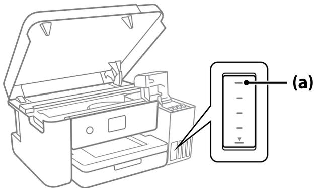
8. Alinhe a parte superior do frasco de tinta com a porta superior, e a seguir coloque-a na porta para encher com tinta até parar automaticamente na linha superior.
