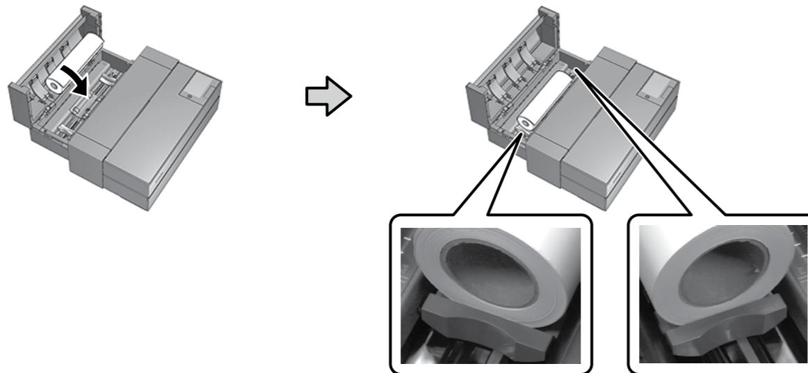
Caricare il rotolo. Controllare che le guide del bordo siano posizionate alle estremità del rotolo.
