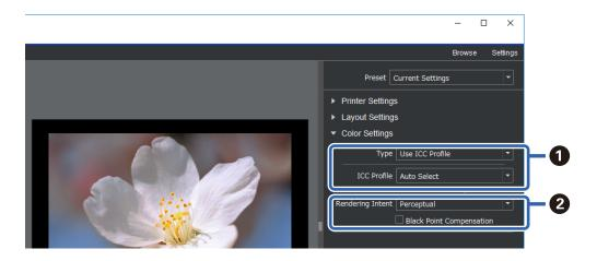
Seleccione Usar perfil ICC en el Tipo. Cuando seleccione Auto selección en Imprimir perfil ICC, el perfil ICC para el papel seleccionado en el paso 2 se establece automáticamente.
