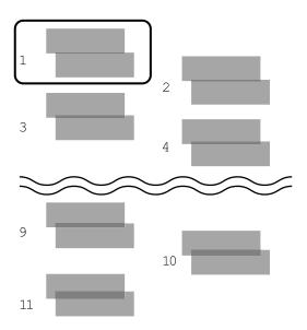
Imprima de nuevo los patrones. Repita estos pasos hasta que pueda seleccionar un patrón sin separación ni superposición.
