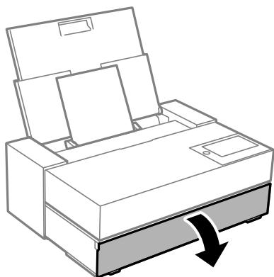
7. Deslice la bandeja de salida hasta su posición máxima.
