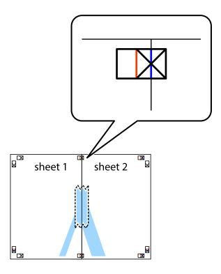
3. Corte en dos las hojas pegadas con cinta por la línea vertical roja atravesando los marcadores de alineación (esta vez, la línea a la izquierda de las marcas de cruz).
