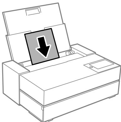
4. Deslice las partes de las guías de borde que se indican mediante (a) hasta los bordes del papel.
