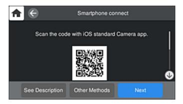
5. En su iPhone, iPad o iPod touch, inicie la aplicación normal de la cámara y luego escanee el código QR que se muestra en el panel de control en el modo de FOTOGRAFÍA.
