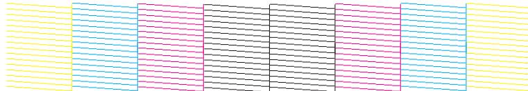
若有任何線條缺漏(如下圖所示)，則表示噴嘴堵塞或印字頭未校正。
