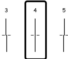
選擇垂直直線性校正時，從第 1 到第 6 組中選擇間隙最少的圖案，然後輸入圖案編號。
