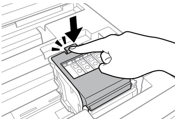
如果墨水匣正確安裝，請按下印表機控制面板上的確定。
