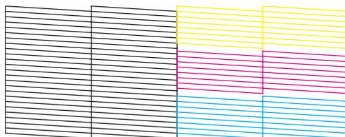
若有任何線條缺漏 (如下圖所示)，則表示噴嘴堵塞或印字頭未校正。
