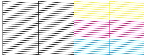
Если отсутствует любой сегмент напечатанных линий, как показано ниже, это может быть связано с забитыми дюзами или с разъюстировкой печатающей головки.
