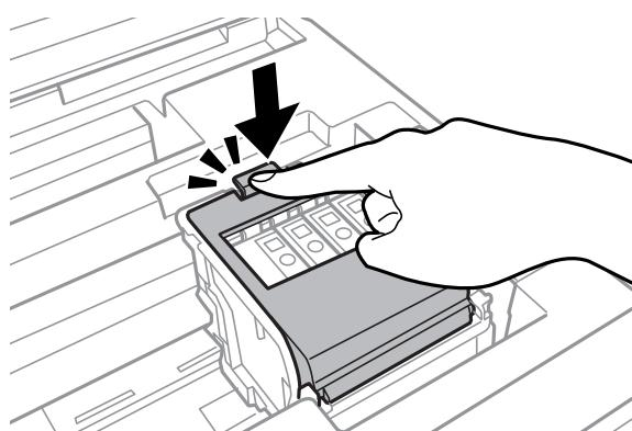
Нажмите **Check (Проверить)** на панели управления устройства, чтобы проверить правильность установки картриджей.
