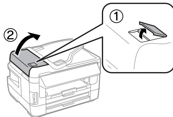
Для серии WF-3620/WF-3640: откройте крышку автоподатчика документов.
