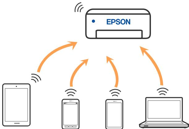
프린터는 Wi-Fi나 이더넷, Wi-Fi Direct (Simple AP) 연결로 동시 연결할 수 있습니다. 그러나 Wi-Fi로 프린터가 연결되어 있는 동안 Wi-Fi Direct (Simple AP) 연결로 네트워크 연결을 시작하면 Wi-Fi 연결은 일시 중단됩니다.
