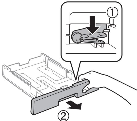
3. Cargue el papel con la cara imprimible hacia abajo y luego deslice la guía del borde delantero hasta el borde del papel.
