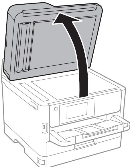
2. Utilice un paño seco, suave y limpio para limpiar la superficie del cristal del escáner.
