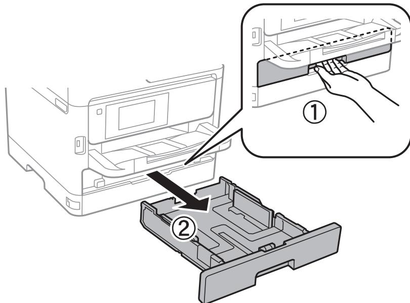
2. Deslice al máximo la guía del borde delantero y luego deslice las guías laterales para ajustarlas al tamaño de papel que desea usar.
