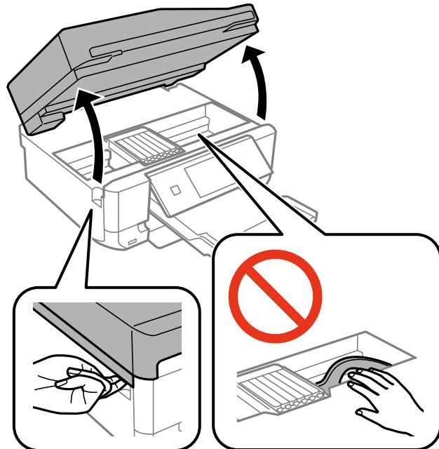
5. Pressione a patilha para desbloquear o suporte do tinteiro e retire o tinteiro na diagonal.
